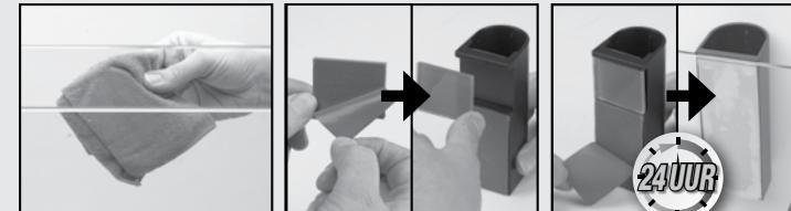
Monteer de lamp op de lampsteen. Schuif de lampsteen in de montagebeugel en steek de vastzetklem in de beugel om de lamp op de gewenste hoogte te houden.
