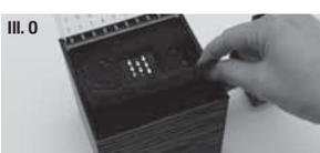
**g)** Replacer d'abord la plaquette de mousse et ensuite la plaquette de filtration.
