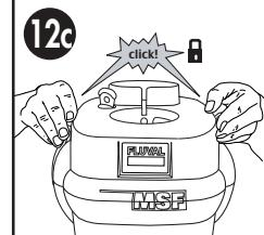
cable de la corriente esté bien alineado con la muesca de la caja del filtro y que las letras "MSF" en la parte delantera estén juntas. Fije la cubierta levantando las palancas superiores de las abrazaderas hasta que se traben con un chasquido. Asegúrese de que la parte inferior de las abrazaderas esté bien enganchada en los puntos de fijación ubicados en la caja del filtro.
