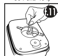
**Warnung (Nur für Modelle 104 und 204): Diese Motoreinheiten enthalten eine Keramikachse. Diese Achse ist für eine sichere Handhabung an ihrer Plastikhaltung dauerhaft angebracht. Die Achse neigt bei seitlichem Druck zu Sprödbruch. Seien Sie deshalb bei der Handhabung überausvorsichtig. Versuchen Sie nicht, die Achse zu biegen.**
